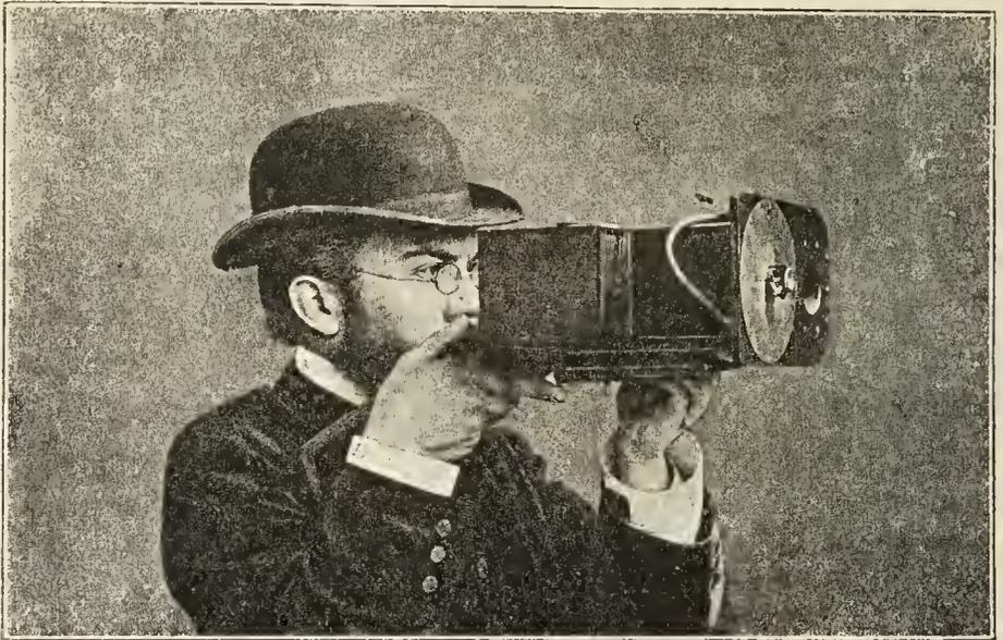
Der Träger der Camera beim Gebrauche ist eine dem Fol'schen Flintenschafte sehr ähnliche Vorrichtung. Sie ist zerlegbar und mit einem sehr einfachen pneumatischen Auslösesapparate versehen. Er besteht aus einem Messingrohre, in welchem ein zweites eingeschliffen ist. Durch Anziehen einer Spiralfeder kann man etwas Luft einsaugen, die beim Losdrücken comprimirt wird; ein Kautschukschlauch trägt die Compression auf den Momentverschluss in der bekannten Weise über.
