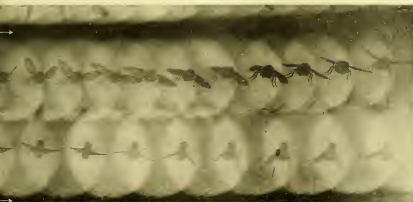
Doppelspiegel. \frac{1}{42000} Sek. Intervalle \frac{1}{2150} Sek.
