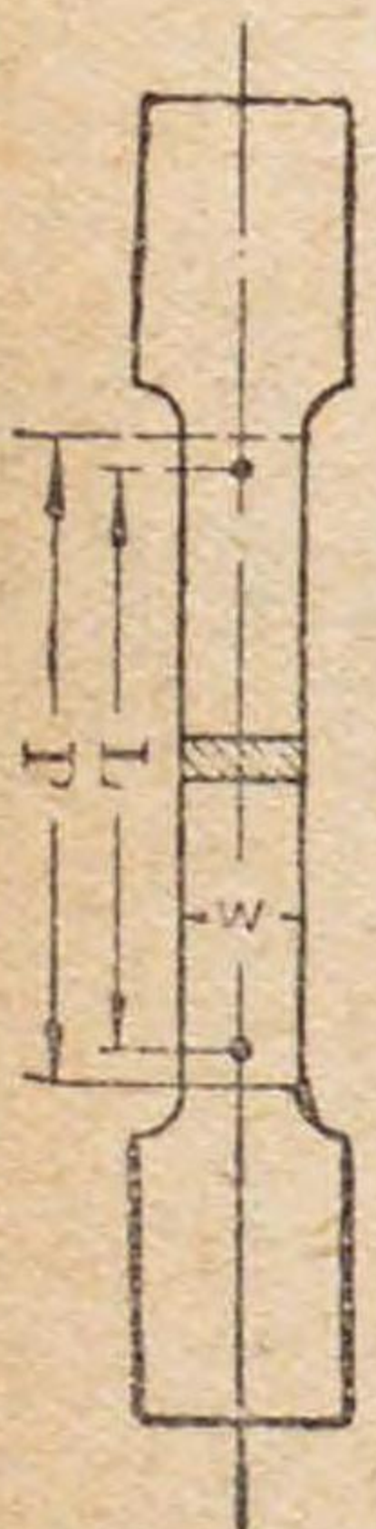
標點距離L 五〇耗 平行部ノ長サP 約七〇耗 厚幅 W 二五耗 原厚サノ儘トス
