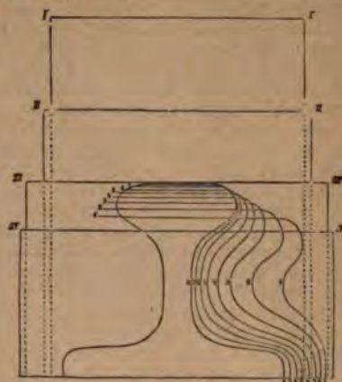
Фиг. 5. Послѣдовательное измѣненіе пакета при прокатѣ рельсоваго желѣза (и стали).
