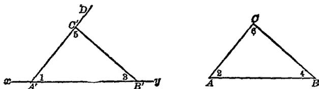
解法：在  $xy$  線上，用圓規截取  $A'B' = AB$ 。用量角器畫  $A'D$ ，令  $\angle 1 = \angle 2$ 。
