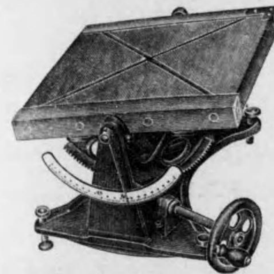
第八十圖 Goniometer (測角機)
