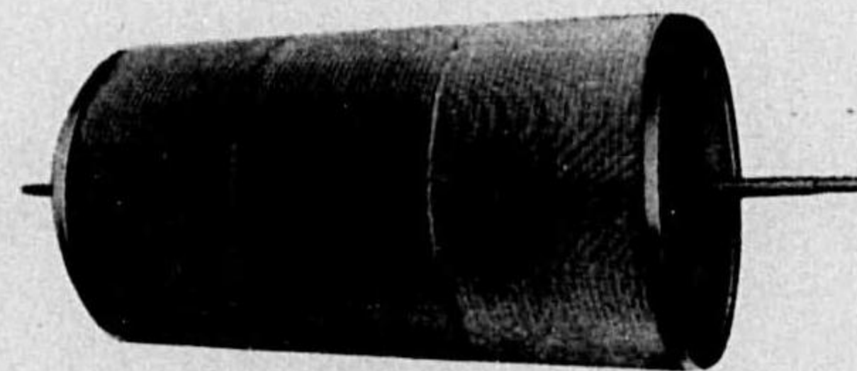
混打棉機ダストケージ
