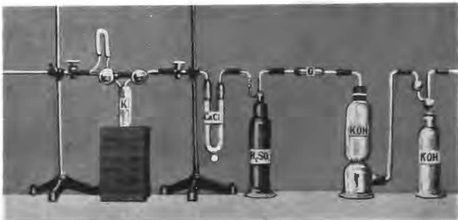
Фиг. 4. Приборъ для изслѣдованія выдыхаемаго утомленными животными воздуха.
