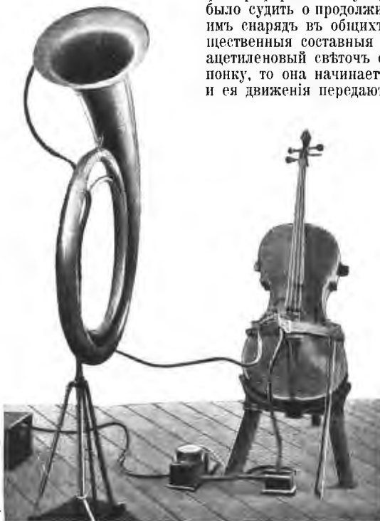
Скрипка съ сжатымъ воздухомъ. Скрипка и труба, соединенные при помощи ауксетофона.
