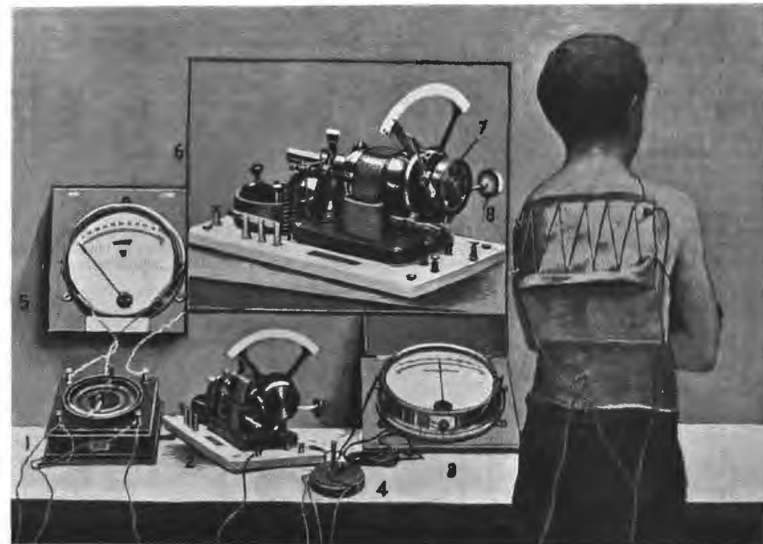
1. Реостатъ для регулированія силы тока. 2. Прерыватель для превращенія прямого тока въ прерывистый. 3. Амперометръ для измѣренія силы тока. 4. Коммутаторъ для измѣненія направленія тока. 5. Вольтметръ для измѣренія напряженія тока. 6—8. Катюшка для тока высокаго напряженія.
