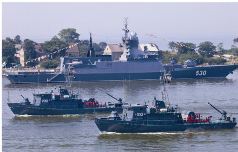
Корабли ПМО пр. 10750Э и корвет пр.20380 с композитной надстройкой производства ОАО «СНСЗ»
