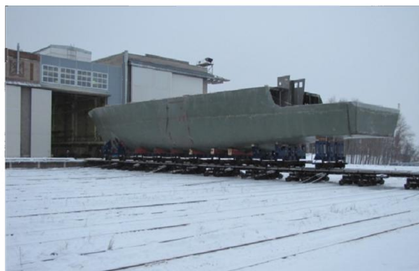
Сформированный методом вакуумной инфузии корпус корабля ПМО после снятия матрицы
