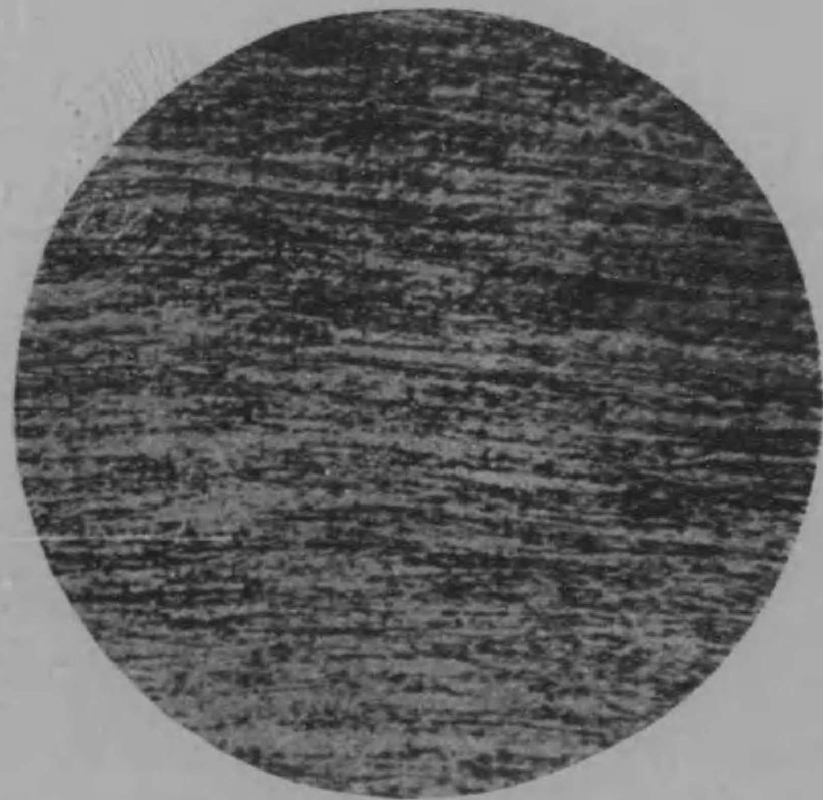
第八圖 直徑0.08時にスエージしたるタングス テン體の縱斷面 纖維組織 廓大約二百倍
