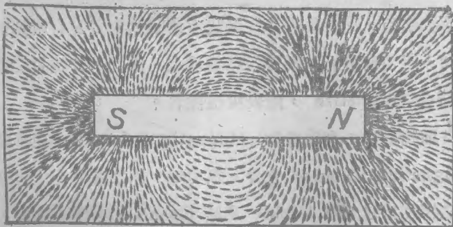
第七十二圖條狀磁石之磁場
