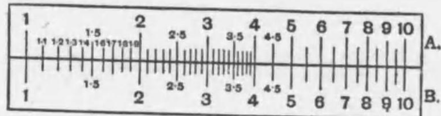
第3圖. 教室デ生徒ノ面前ニ於テ數分間ニ作り上ゲタ計算尺
