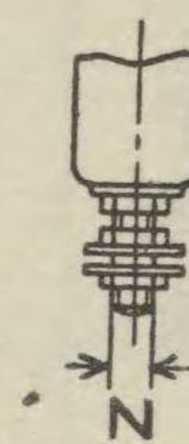
第6圖 600A 以上用端子寸法圖
