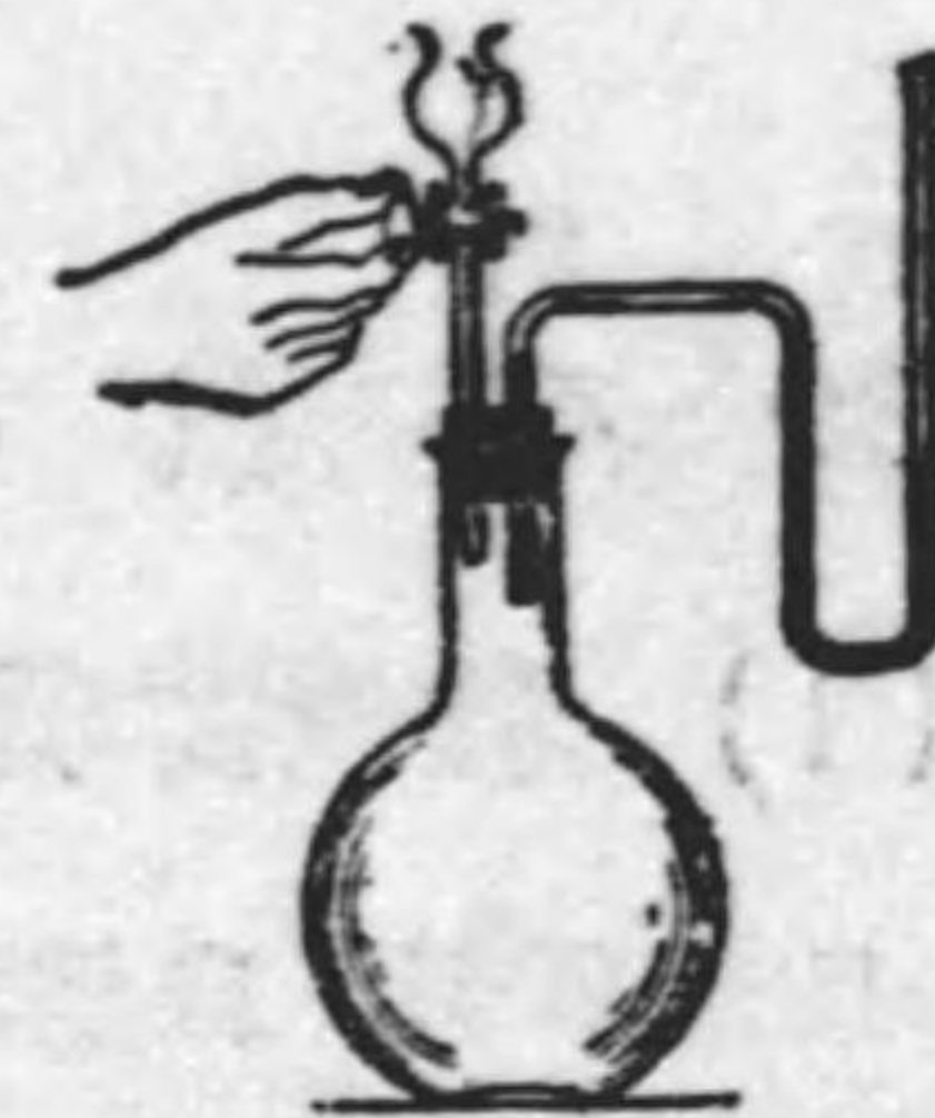
(蒸氣の最大壓力を見る實驗別法)
