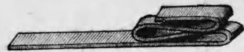
第八十六圖 平鐵鍛錬試験片
