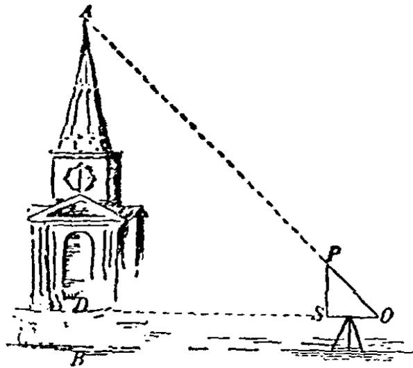
在地平面  $BC$  上取適宜之位置置一几, 令几面與地平面平行; 几上置一直立之三角板  $POS$  ( $S$  為直角), 置眼於  $O$  以望  $A$ , 進退几面, 使  $O, P, A$  可在一直線上。次, 在  $OS$  之方向望建築物, 得見  $D$  點, 而  $OD$  為可量其長之距離;
