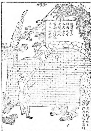
圖 73. 我 國 古 代 的 瓷 器 窯 (採 自 宋 應 星 著 天 工 開 物)
