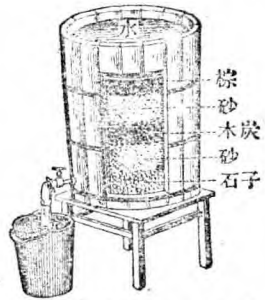
圖 15. 家庭用濾水器 (表示內部構造之剖面)
