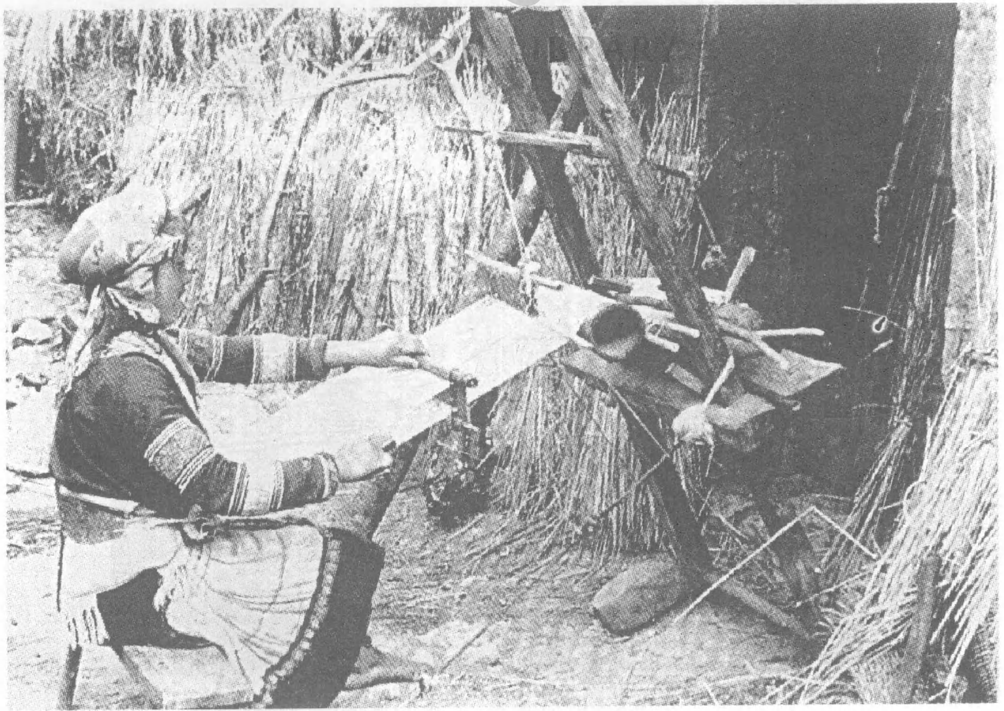
11-1.3-a 云南文山苗族使用的斜架式原始悬轴织机，也称梯架式织机。
