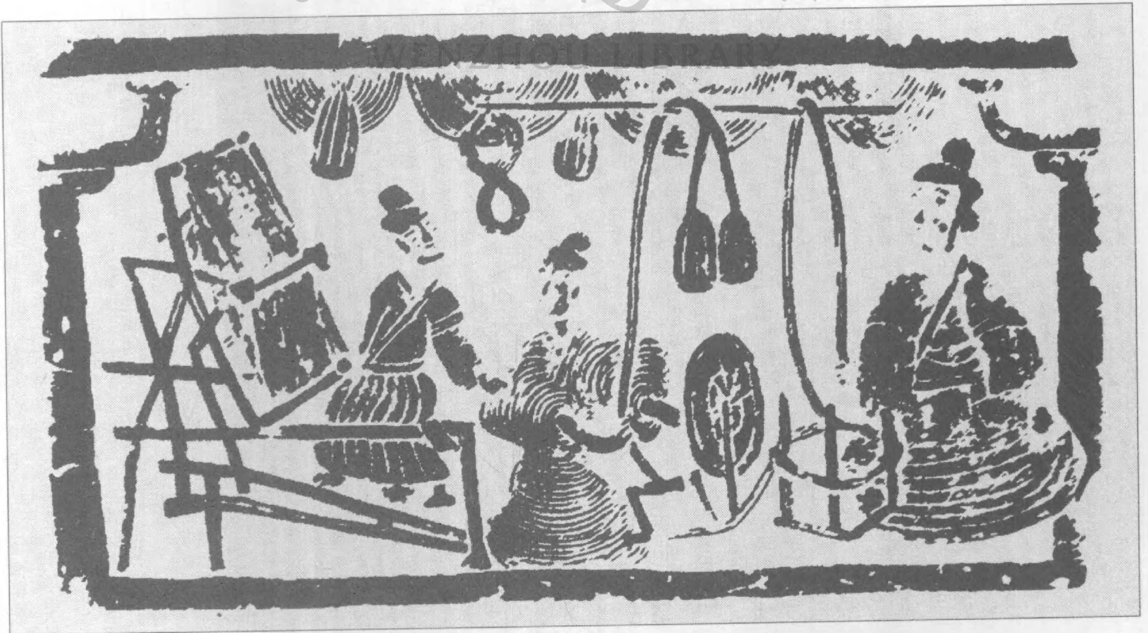
11-3.2-b 江苏铜山县洪楼地区汉画像石上的中轴式踏板斜织机。
