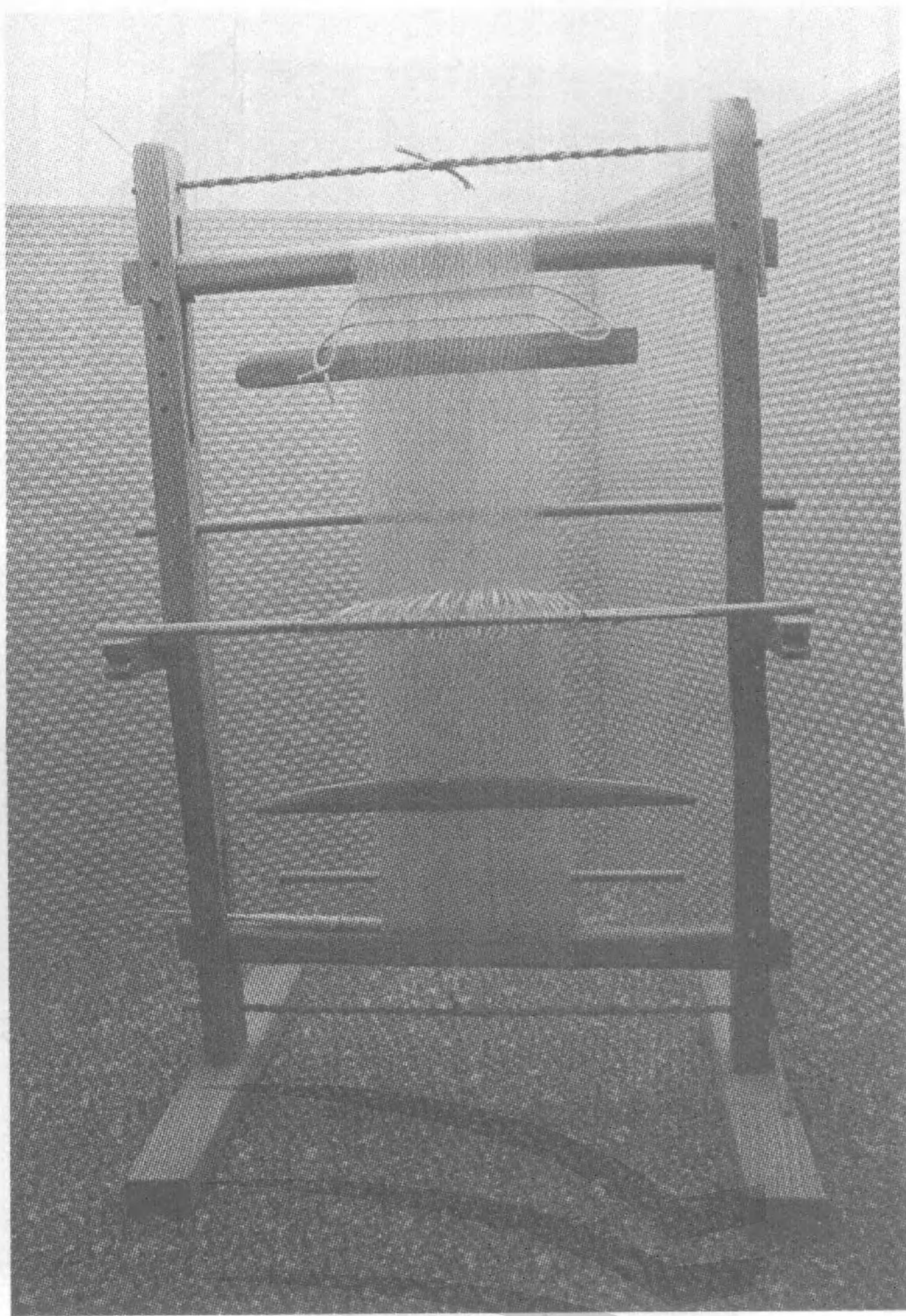
11-2.2-a 根据古埃及墓室壁画织机复制的垂直式双轴织机模型。
