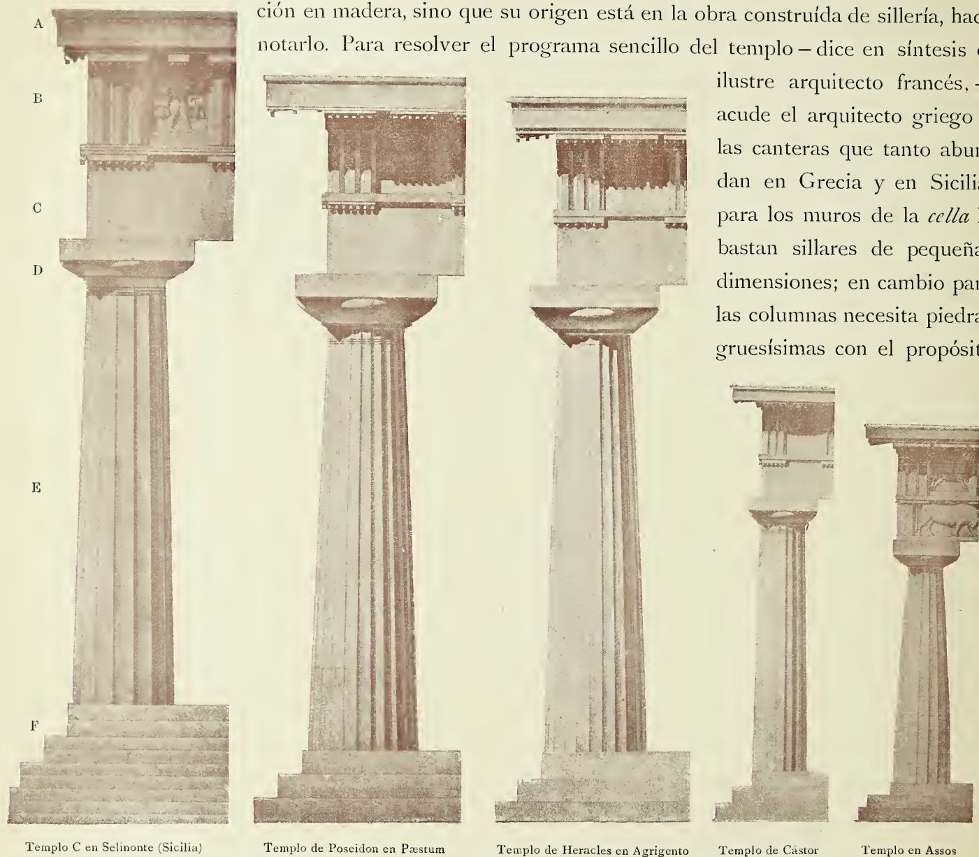
Fig. 305. — CUADRO COMPARATIVO DE COLUMNAS Y ENTABLAMENTOS DÓRICOS
