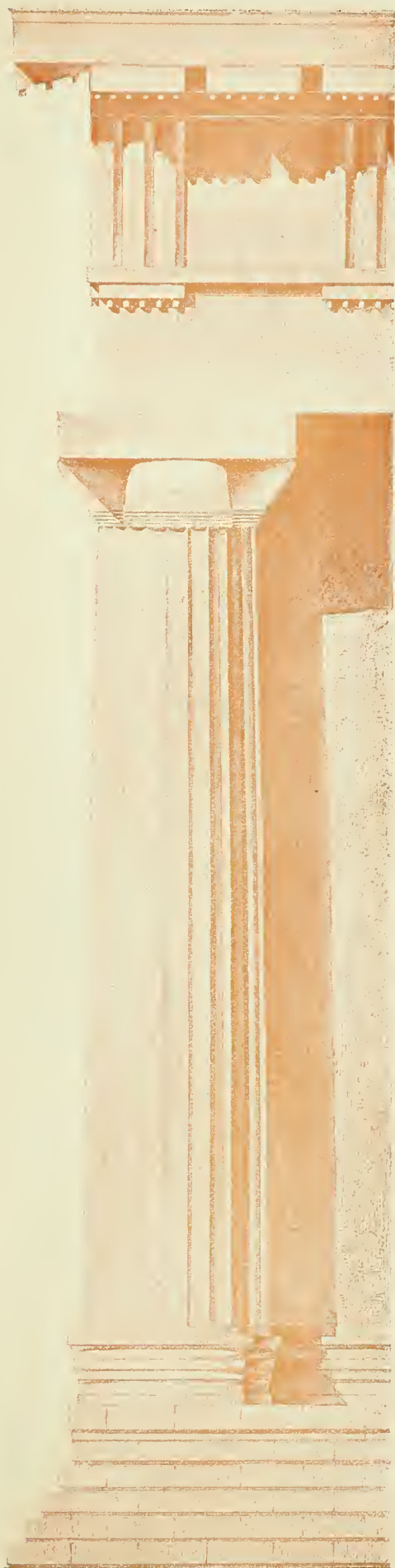
Fig. 314. — COLUMNA DEL TEMPLO DE ZEUS EN AGRIGENTO. Escala 1/100
