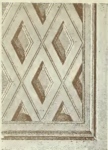
Fig. 369. - ARTESONADO DE LOS PÓRTICOS LATERALES DEL TEMPLO DE BASSÆ, SEGUN BLUET.
