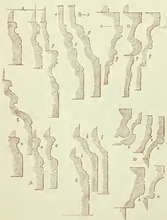
Fig. 1057. - COMPARACIÓN ENTRE MOLDURAS SIRIAS Y ROMÁNICAS, SEGÚN VIOLLET
