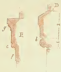
Fig. 1055. - COMPARACIÓN ENTRE PERFILES DE IMPOSTA ROMANOS Y ROMÁNICOS, SEGÚN VIOLLET.
