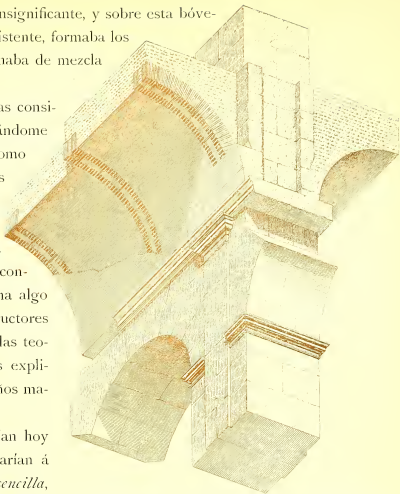
Fig. 502. — BÓVEDA DE MAMPOSTERÍA REFORZADA POR ARCOS DE LADRILLO (ACUEDUCTO INMEDIATO Á LA IGLESIA CIRCULAR DE SAN ESTEBAN EN ROMA).
