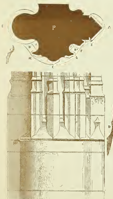
Fig. 1280. — BASE DEL PÓRTICO DEL HOTEL DE LA TREMOILLE EN PARÍS, SEGÚN VIOUET.
