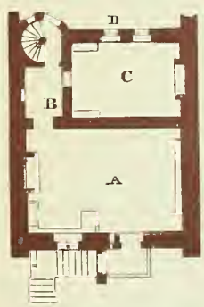
Fig. 1108. - PLANTA DE UNA CASA DE PRINCIPIOS DEL SIGLO XII, SEGÚN PLANOS LEVANTADOS EN BORGONA, EN EL NIVERNÉS Y LA CHAMPAÑA (VIOLETTE-DUC).
