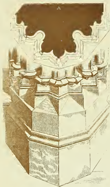
Fig. 1279. — BASE DE COLUMNA EN EL CORO DE SAN NAZARIO EN CARCASO, SEGÚN VIOUET.
