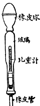
第 59 圖 檢驗蓄電池 用之注射式比重計
