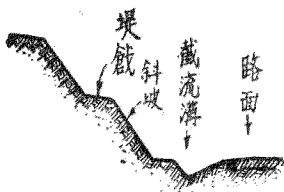
第72圖 堤餞護坡
