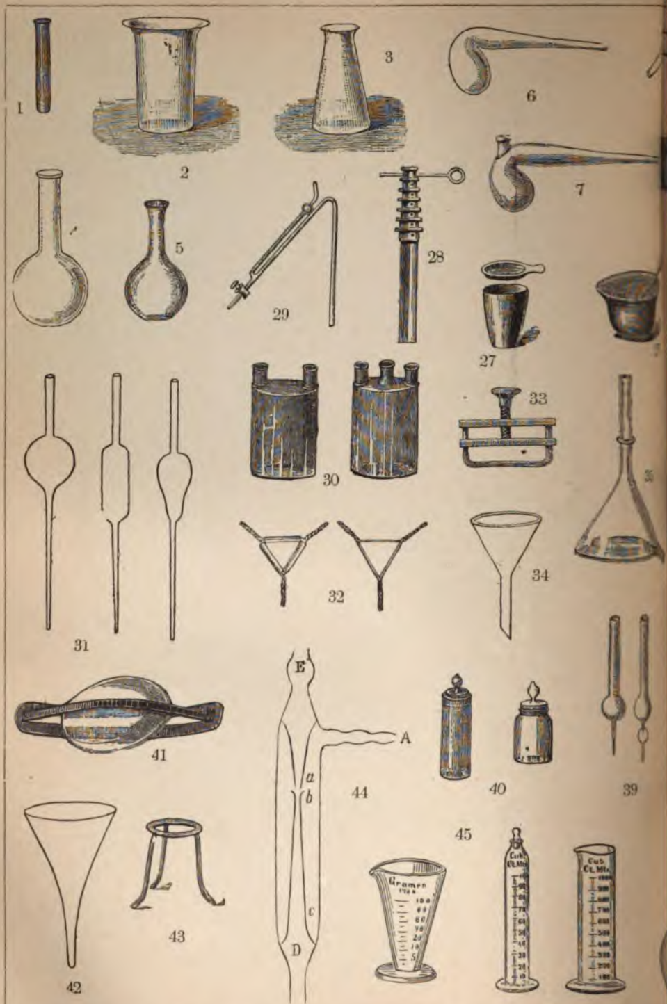
1 Пробирка. 2. Стаканъ. 3. Колба коническая. 4. Баллонъ. 5. Колба, 6 и 7. Реторты. 8. Алмондъ. 9. Аляскинъ. 10. Ножъ для точенія сверла. 11. Тигельные щипцы. 12. Тройная горелка Вуллена. 13. Насадки для горелки. 14. Калъ-аппараты Гейслера. 15. Ступка фарфоровая. 16. Ступка желъзная. 17. Кристаллизаторъ. 18. Платиновая воронка съ угломъ 60°. 19. Воронка В. Мейера. 20. Щетка для чистки пробирокъ. 21. Сканька Дрейсселя. 22. Пасось Альверсия. 23 и 24. Измърятельные сосуды. 25. Штативъ для бюретки
