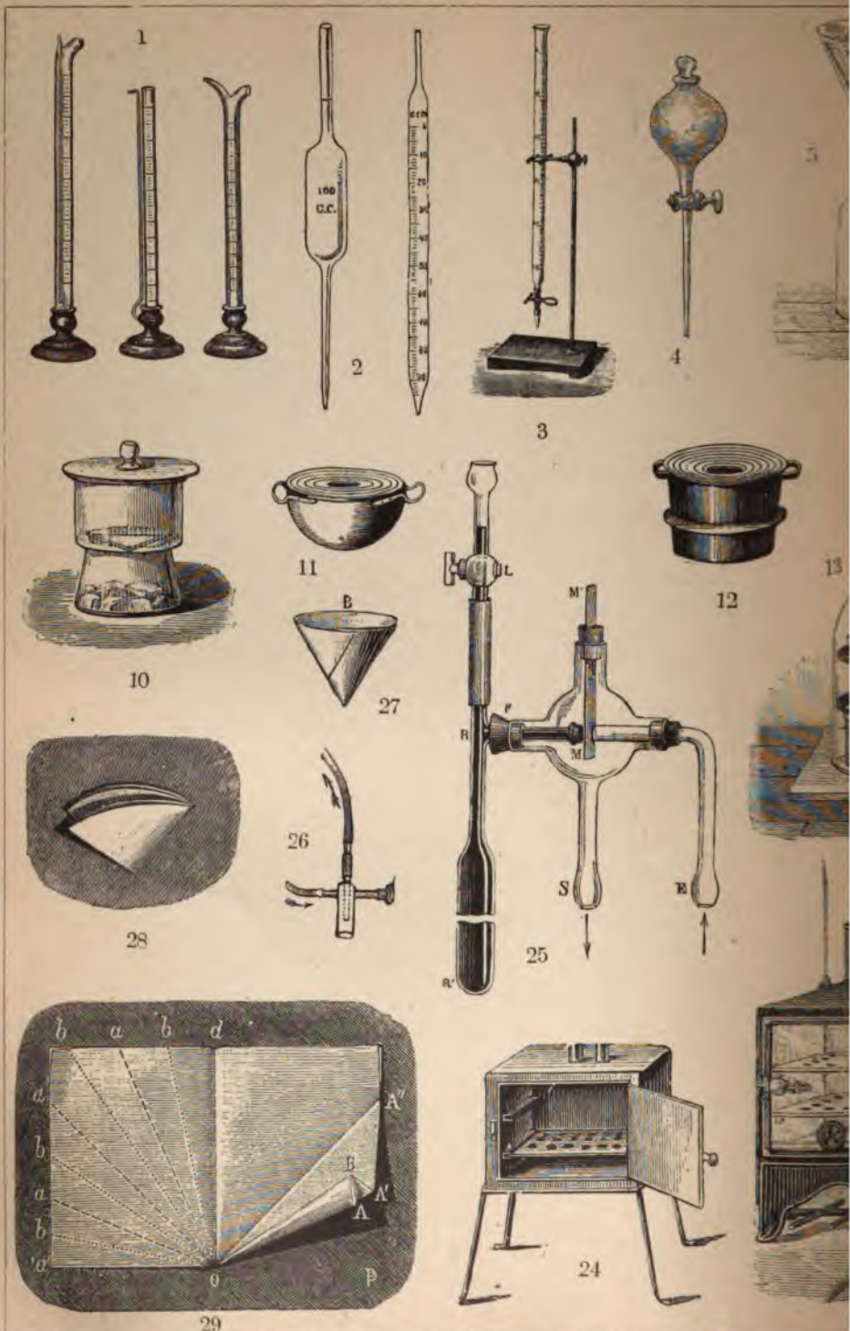
1 и 3. Бюретки. 2. Градуированные пипетки. 4. Раздвигательная воронка. 5. Фильтрование через плоский фильтр Рейхарта. 10, 13, 14 и 22. Эвaporаторы. 11, 12 и 16. Водяные бани. 17. Спиральный холодильник. 24. Воздушная баня. 25. Регулятор Шленка. 26. Водяной регулятор.
