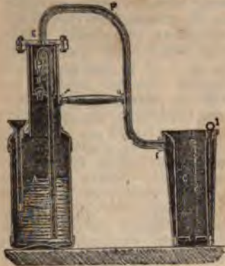
Фиг. 1. Машина Карре.
