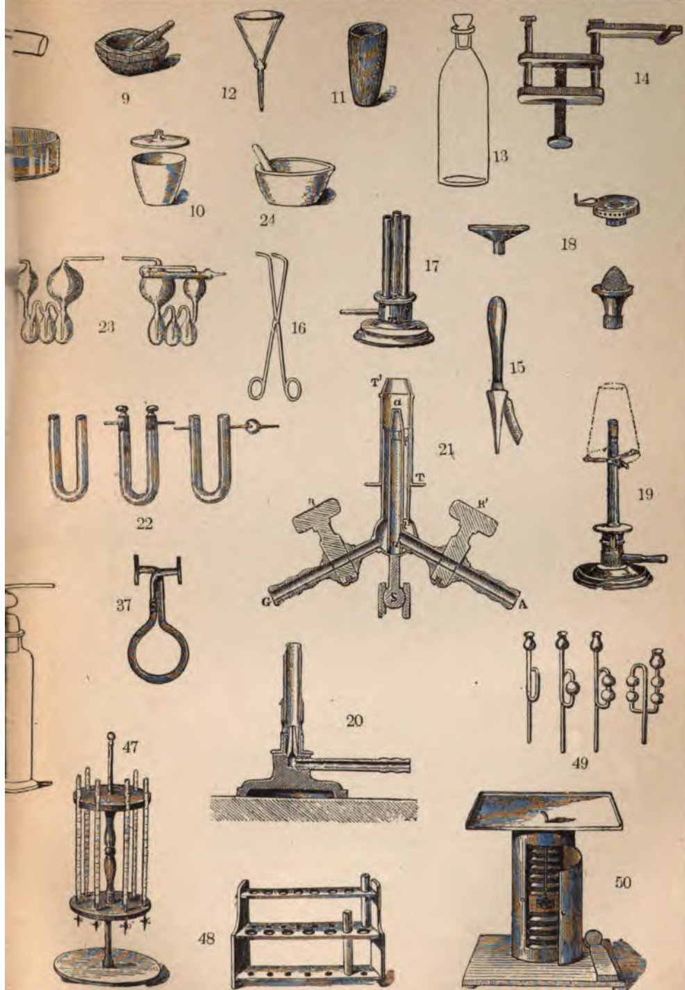
9. Тигель фарфоровый. 11. Тигель гессенский. 12. Воронка съ шариками. 13. Реактивная склянка. 14, 33 и 37. За Горьла Фишера. 20. Горьла Вуаена. 21. Пальная лампа. 22 и 39. Трубки для поглощенія и сушенія газовъ. 28. Наборъ пробочныхъ сверлъ. 29. Сифонъ. 30. Вульфова склянка. 31. Пипетки. 32. Тригольникъ для тиглей. 34. вальшмава. 41. Часовыя стекла съ зажимомъ. 42. Воронка съ угломъ 45°. 43. Трехножникъ. 44. Водно-воздушный тигель для пробирокъ. 49. Предохранительныя воронки Вальтера 50. Пальный столъ.
