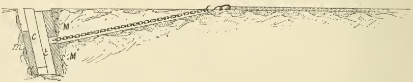
Fig. 53. — Madriers pour le câble de retenue.
