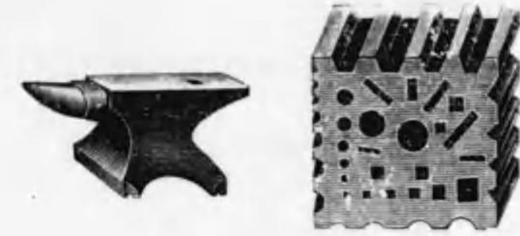
鍛冶工場用鍛錬臺 左. 金床 右. 穴床
