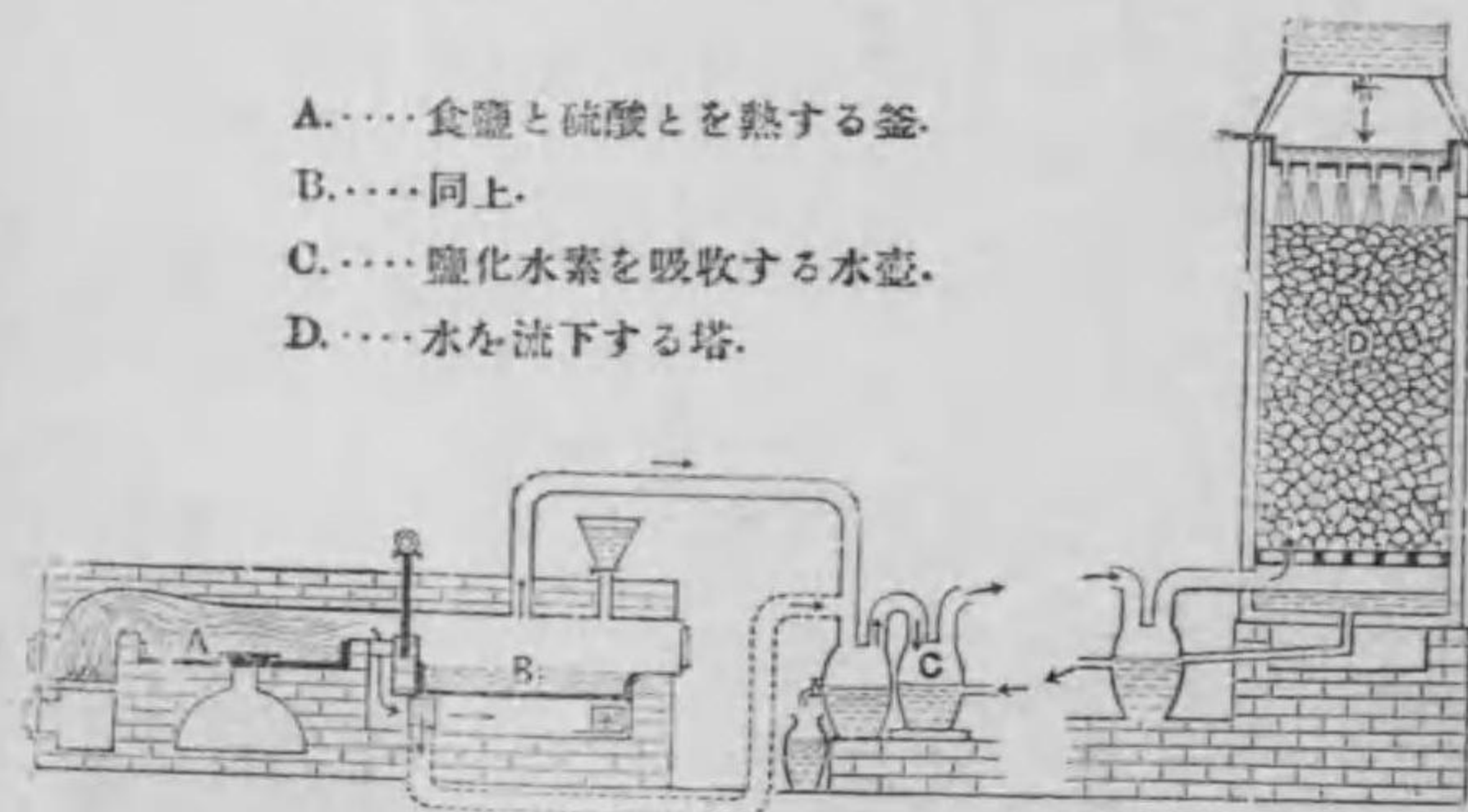
第43圖—鹽酸を工業的に製造する裝置.
