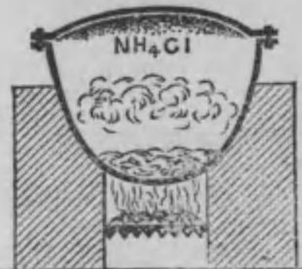
第49圖—鹽化アムモニウムを精製す。
