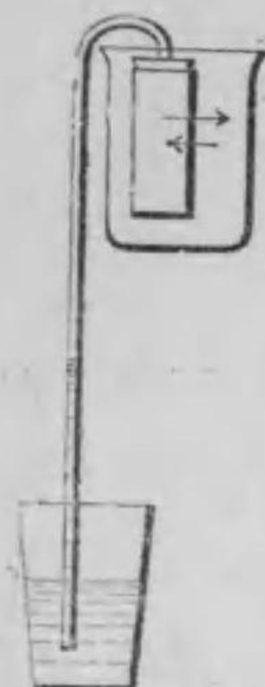
第29圖—無水炭酸の擴散が空氣より速きを示す。(3)
