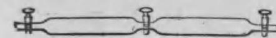
第41圖—鹽素と水素と等體積化合して鹽化水素を生ずるを示す。
