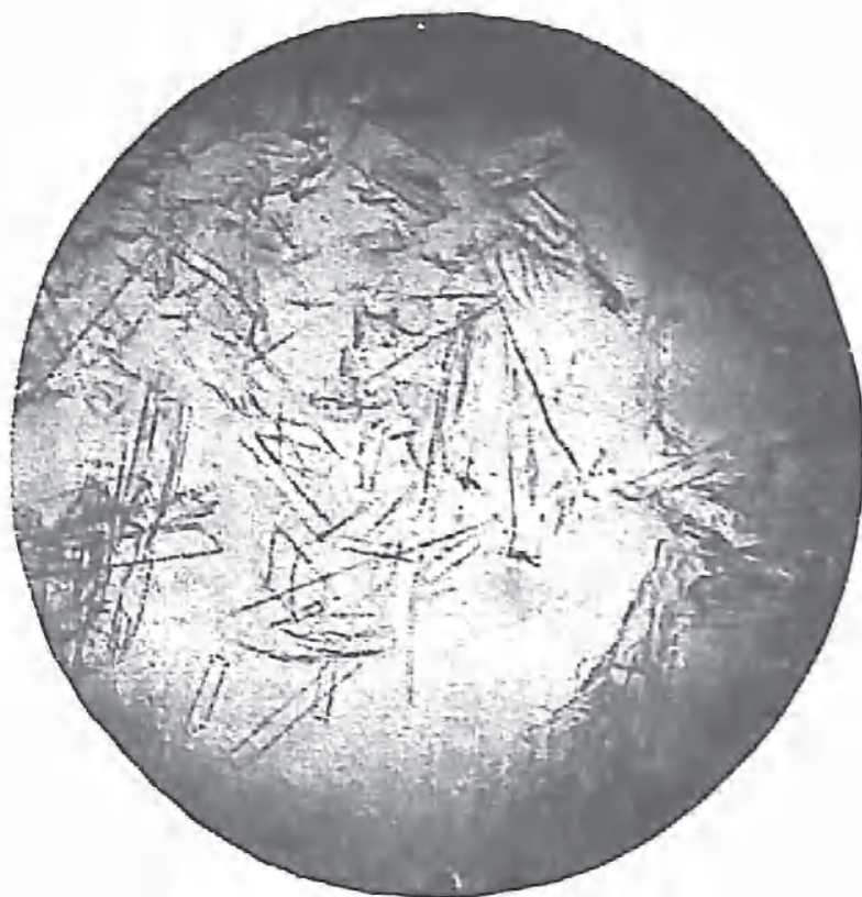
第二圖 在顯微鏡下察視硬脂鈉淡水溶液之圖 ×36 dia.
