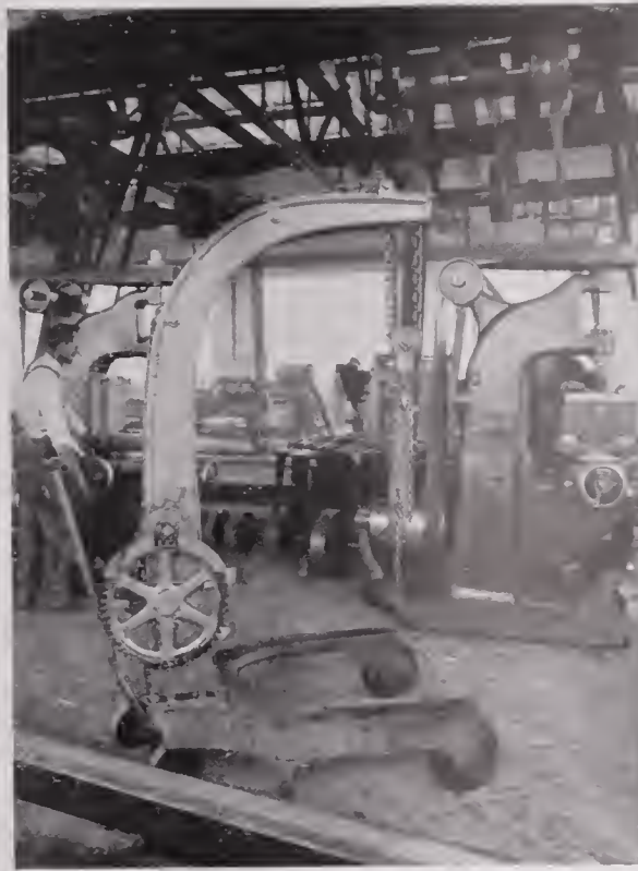
CANTON PORTABLE HOIST CRANE
