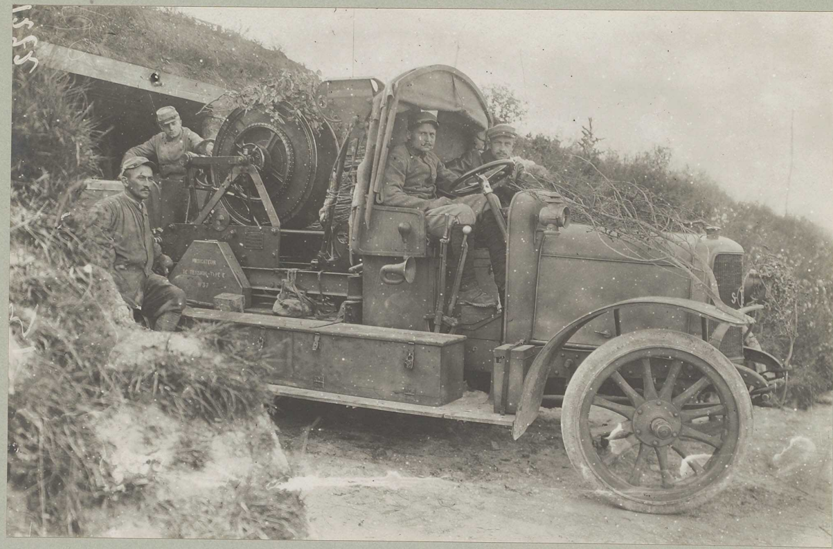
Treuil automobile du ballon d'observation de la 57 e C ie d'aérostiers.
