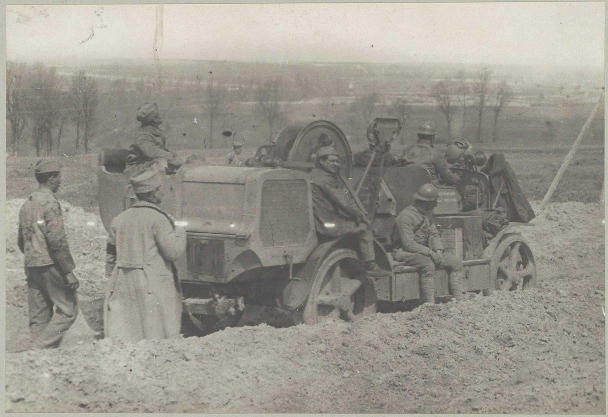
Tracteur automobile d'un ballon d'observation.
