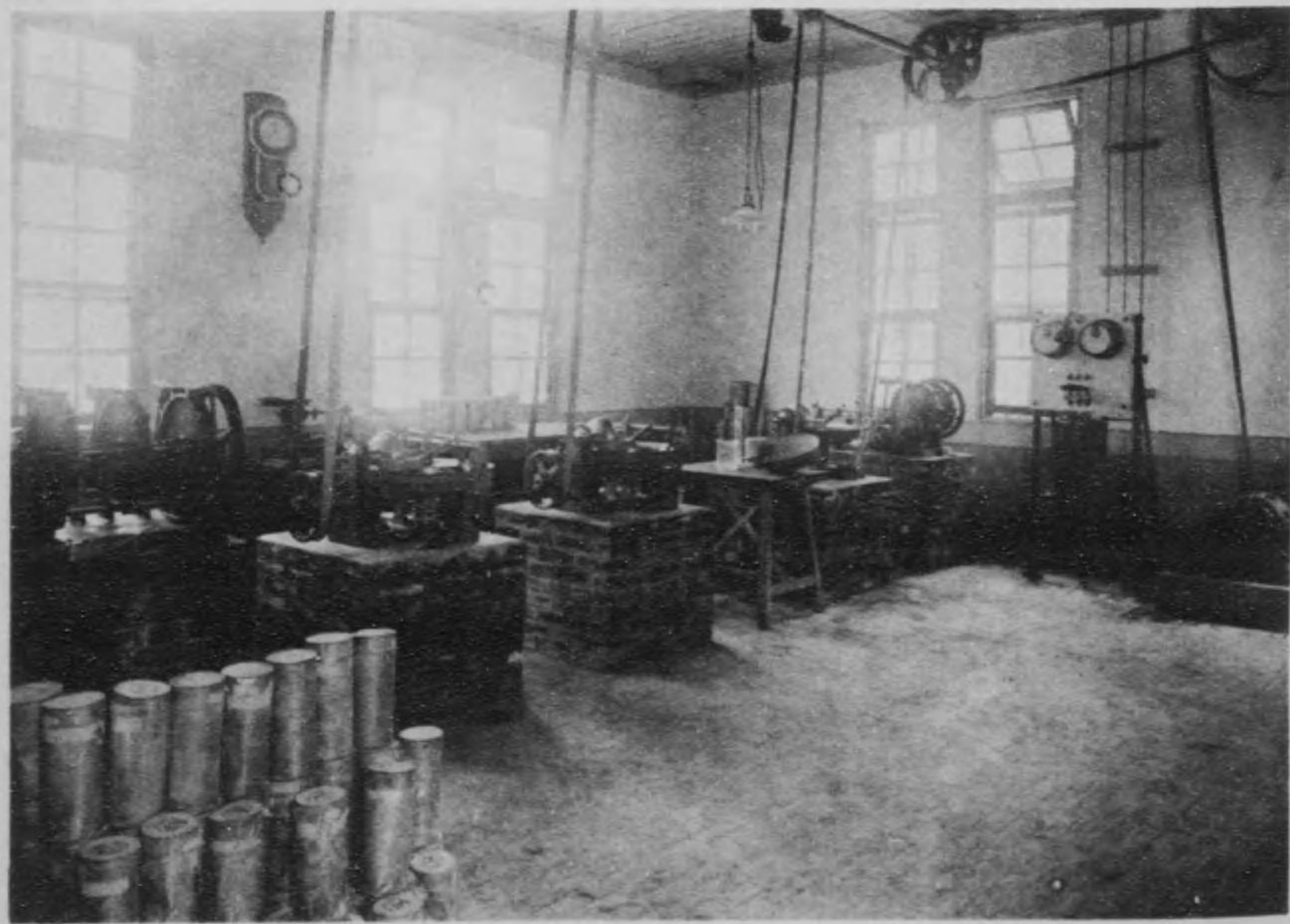
「セメント」強力供試牀成形室
