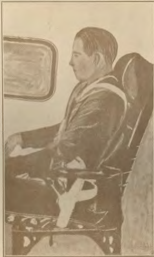
圖(9) 在房艙飛機內穿帶曲背式保險傘坐於靠椅上之勢姿。
