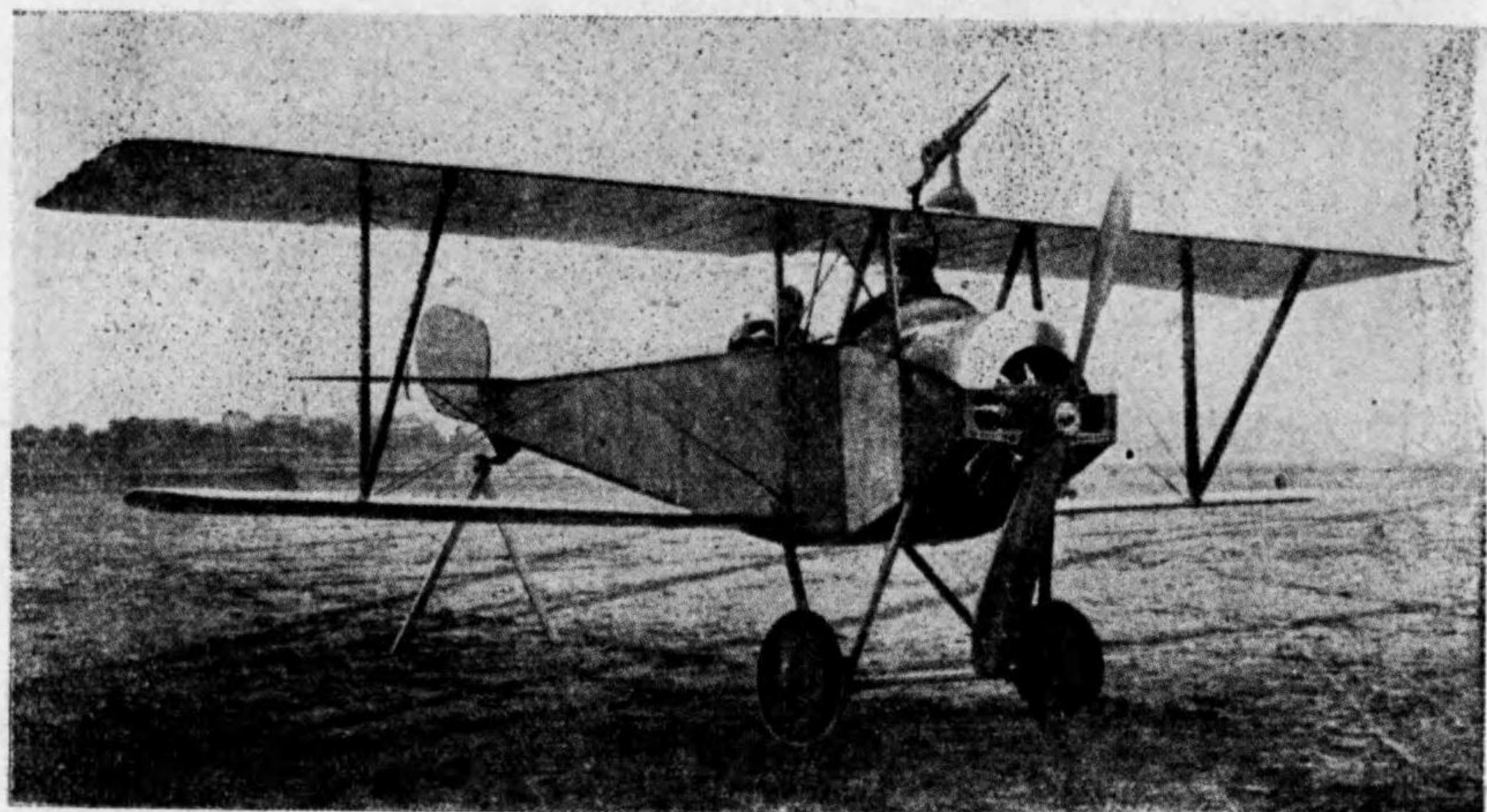
翼の上の機銃を据えたるニル一人乗機
