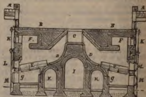
Фиг. 2. Соро-сжигательная печь Горсфалля. А А—Водопадъ, В В—платформа, С—шахта для вращенія очага мусоромъ, D D—очагъ, E E—колосники, F F—выходъ печныхъ газовъ въ сжигательную камеру, G G—зольникъ, H H—протозный каналъ для воздуха, I—главный дымоотводный каналъ, K K—двери для чистки, L L—двери для удаленія шлака, M M—двери для удаленія золы.
