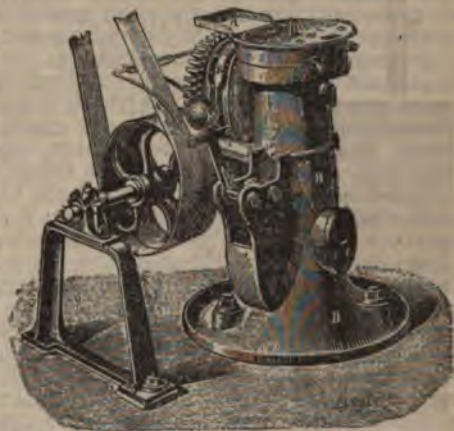
Фиг. 2. Наружный видъ пресса. А—площадка, прижимающая навѣску; ВВ—внѣшній корпусъ пресса; Р—конецъ поршня.
