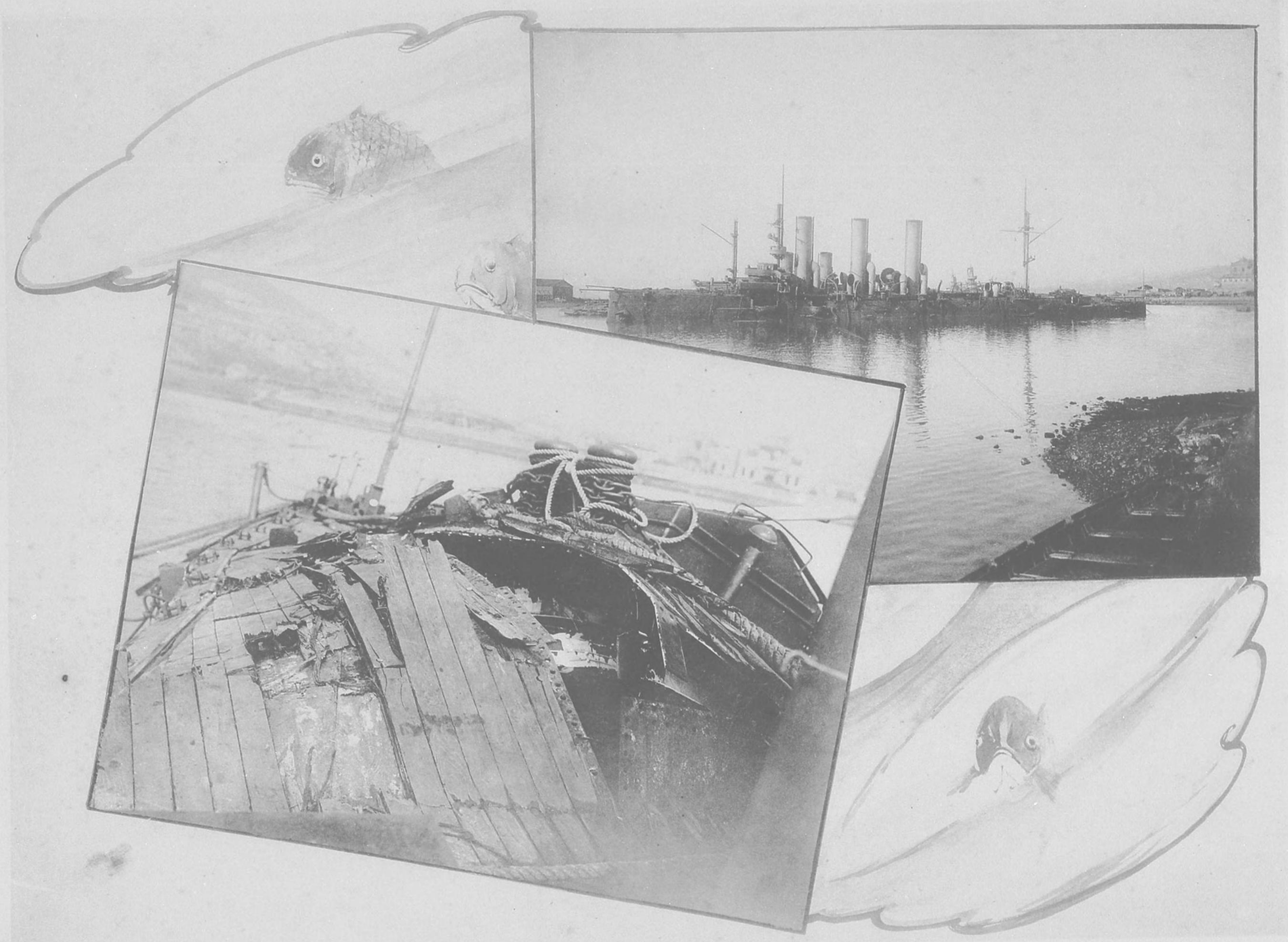
ム望ヲ舷左ノ「ダラルバ」艦洋巡リヨ頭埠港東 (狀現破爛ノ板甲部後艦同 圖下)
