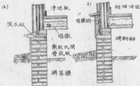
圖 13 底樓板層和木框架牆的连接：
