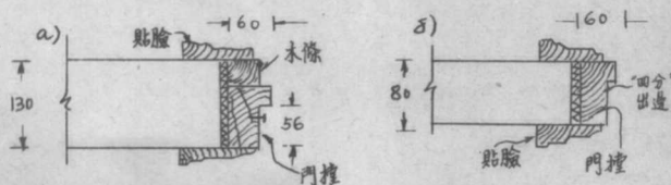
圖5. 厚度不同的隔斷中安裝門樑，
