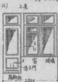
圖 8. 踢脚板高金屬板的入口門扇。
