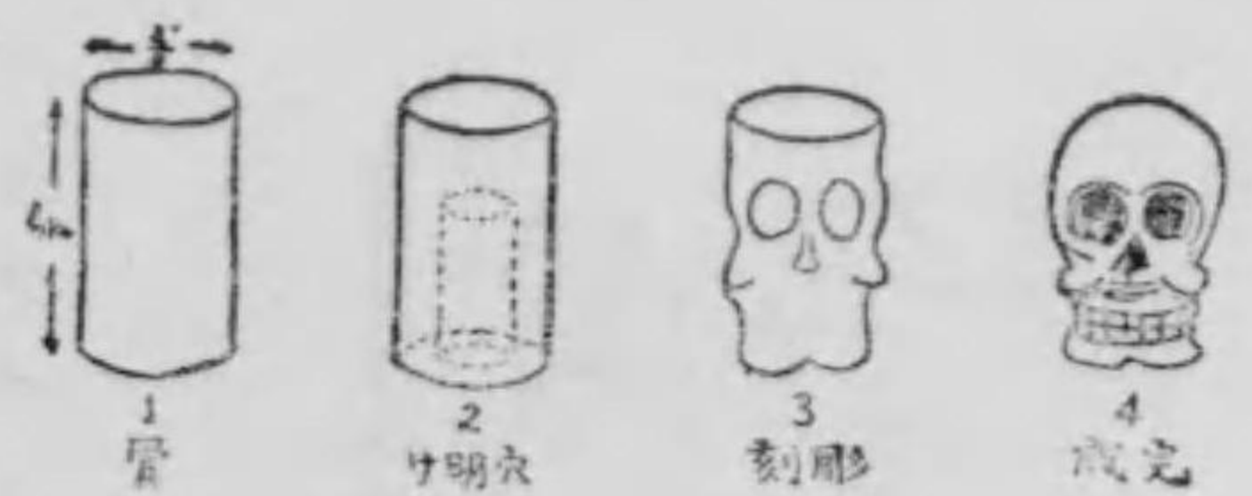
第三百三圖 電氣ピン彫刻の順序
