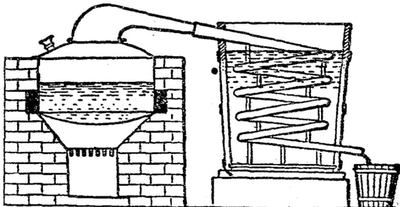
煮沸，讓水變成了汽，水汽通過螺線狀的管子，管子浸在冷水桶裏，水汽在細管子裏面便可以慢慢的凝成了水，便是淨水。這個法子最好，一切的雜質都可以去掉。醫院，藥房，和各
