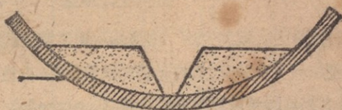
圖 26. 畫溝器劃開後皿中土壤形狀
