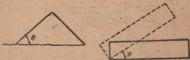
圖 5. 內阻力角簡單測法
