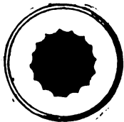
Поперечный разрѣзъ шестнадцатигранной колоны съ ложбинами.
