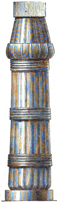
Шестнадцати-сте- бельная колонна-лотось.
