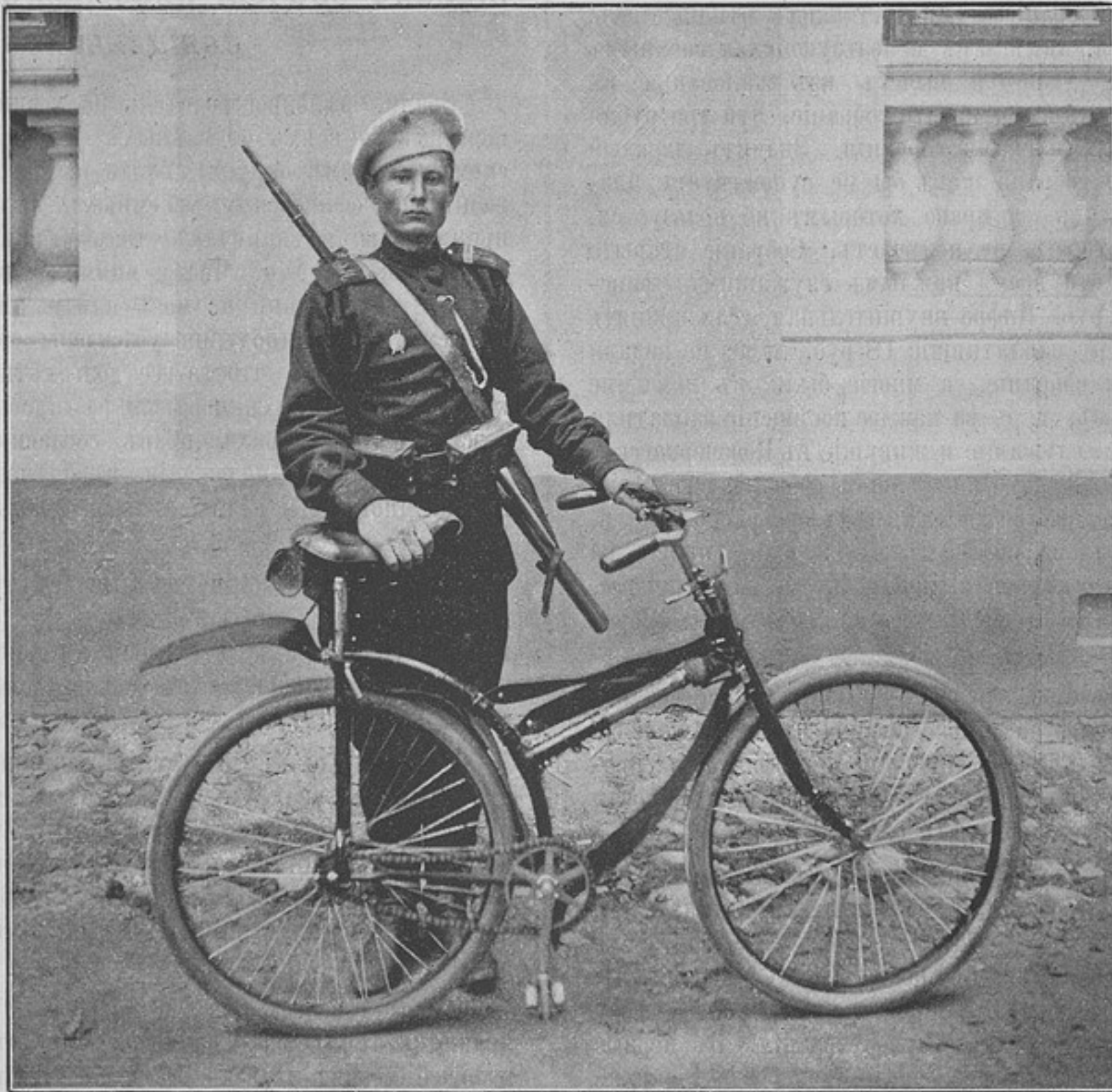
Фиг. 1. Спрямленный самокатъ Жерара, мод. 1897 г. (къ статьѣ «Самокатъ Жерара»).
