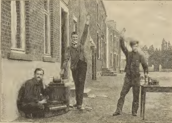
Fig. 1. - Tres ayudantes que realizan la telegrafía sin hilos con el cuerpo humano como antena
