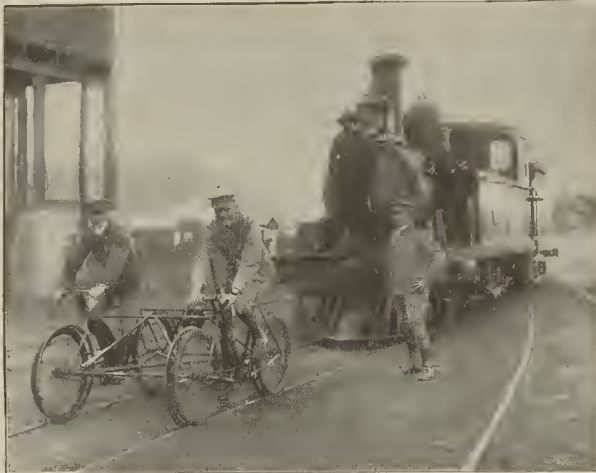
VELOCIPEDO ADAPTABLE Á LAS VÍAS FÉRREAS, INVENTADO POR EL MAYOR OWEN-LEWIS Y UTILIZADO ACTUALMENTE POR LOS INGLESES EN EL AFRICA DEL SUR
