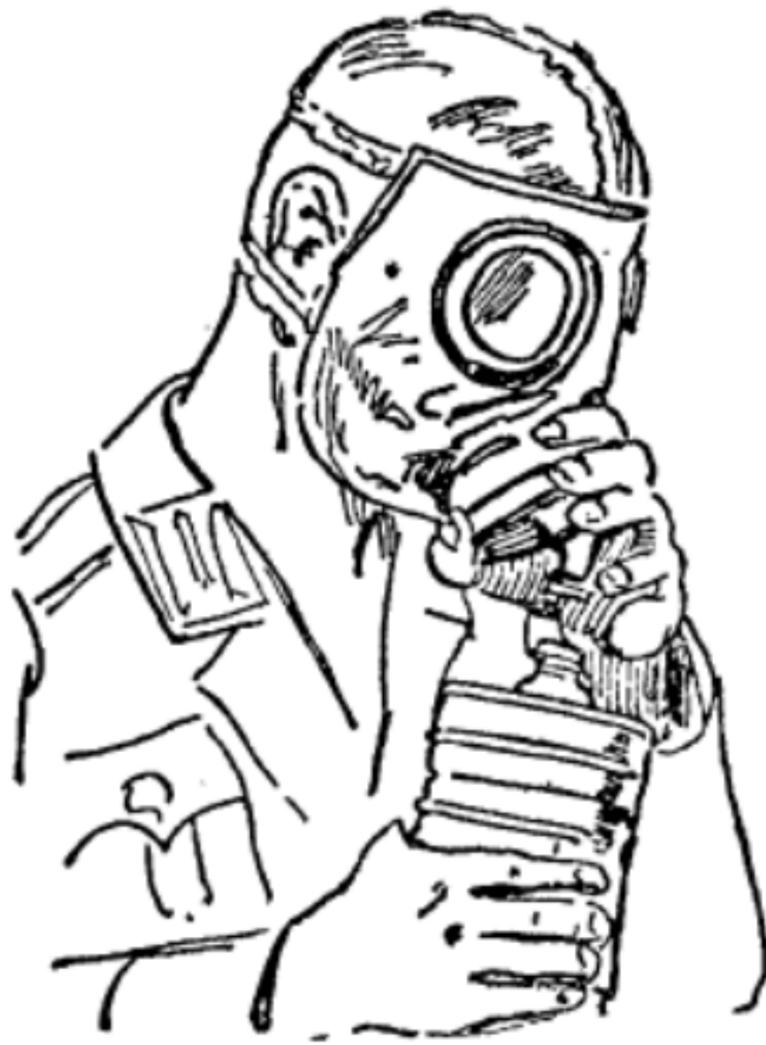
於撤毒地拆換損壞的呼吸橡皮
