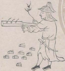
用熟鐵團造長一尺二寸、徑二寸二分、後筒三寸、安木拐欄、腹面上鑿一隙、從前進小砲三箇、各長三寸、徑一寸七分、上連拐釘入隙、不滾藥線、小砲裝藥八分、入二錢鉛子二箇、遇敵夾打、
