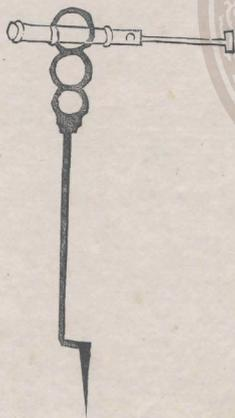
用熟鐵團打工精、短者二三尺、長者四尺、止于底、鑽眼後安木柄、拐前用鐵圈扶住、照準對打、
