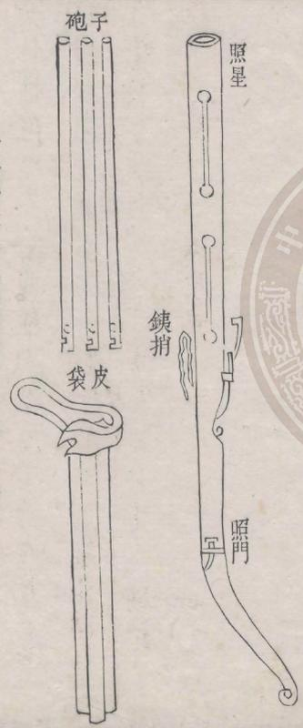
母砲長一尺六寸、底上少許有孔、旁繫鐵梢、底至火門一寸六分、子砲長一尺七寸、底梢上有門、底至火門一寸、如望下放打、以梢從孔、關住子砲之間、以防倒出、
