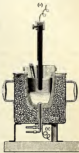
Fig. 3. Elektrischer Lichtbogenofen von Siemens.
