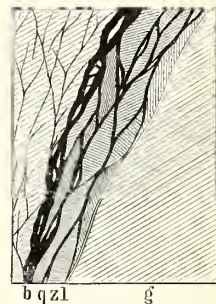
6. Einfacher Gang. 7. Zusammengesetzter Gang. g grauer Gneis, l Lettenbesteg, q Quarz, z Schollen zersetzter Gneises, zi Zinkblende, b Bleiglanz.
