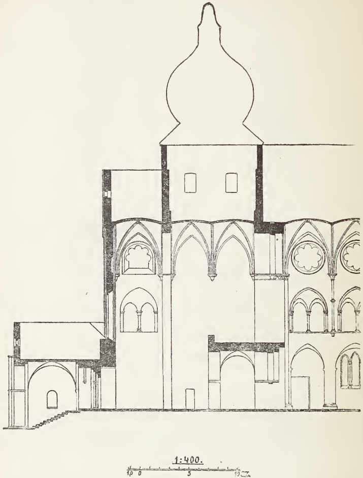
Fig. 147. Längenschnitt durch Peterskirche und Paradies vor der Restauration von 1840—50. (Nach Stüler und Lohde.)
