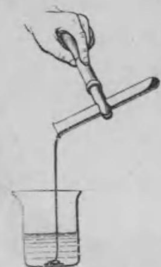
第61圖—沸騰せる硫黄を冷水に注ぎてゴム状硫黄を製す。
