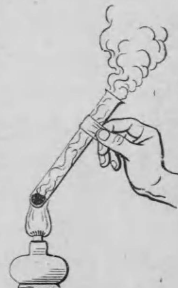
第 80 圖—木質を熱して炭化せしむ。
