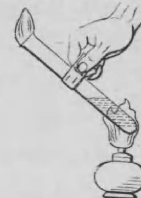
第76圖—硼酸エチルの燐色により硼素を鑑識す。
