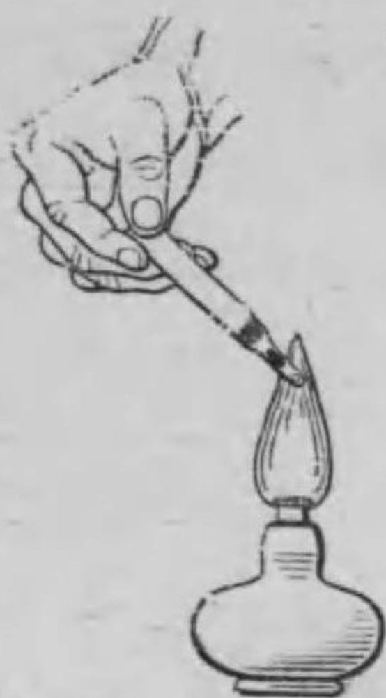
第77圖—無水亞砒酸に木炭末を混じて熱し砒素を昇華せしむ。
