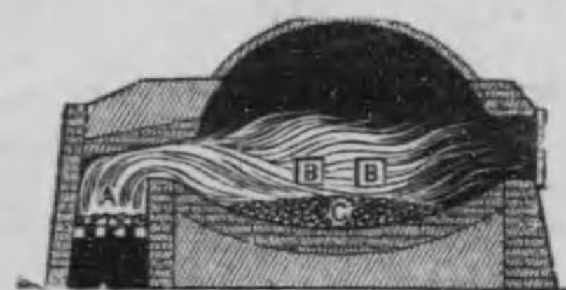
第114圖—灰吹爐。 A. 石炭 B. 鼓風口 C. 骨灰床。
