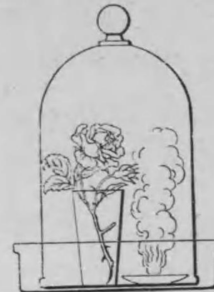
第65圖一硫黄の燃焼により生ずる無水亞硫酸にて草花を褪せしむ。
