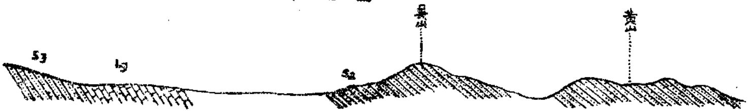
第十一圖 長興南山 S3 褐色雲母石英岩 L3 青石灰岩 S2 石英性砂岩間煤層 比例 1:50000
