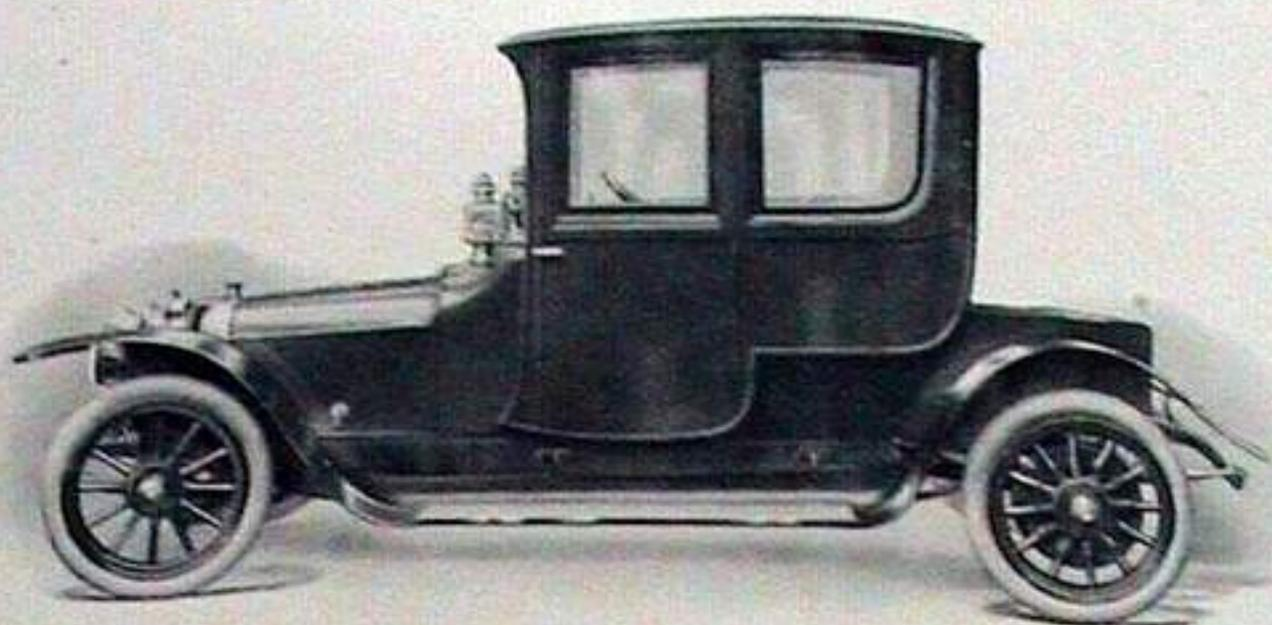
Glace avant pouvant se mettre en auvent — Deux phares à générateur séparé et lanternes Ducellier — Trompe.
