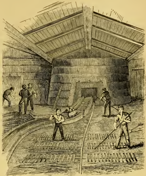
CASTING PIG IRON.
