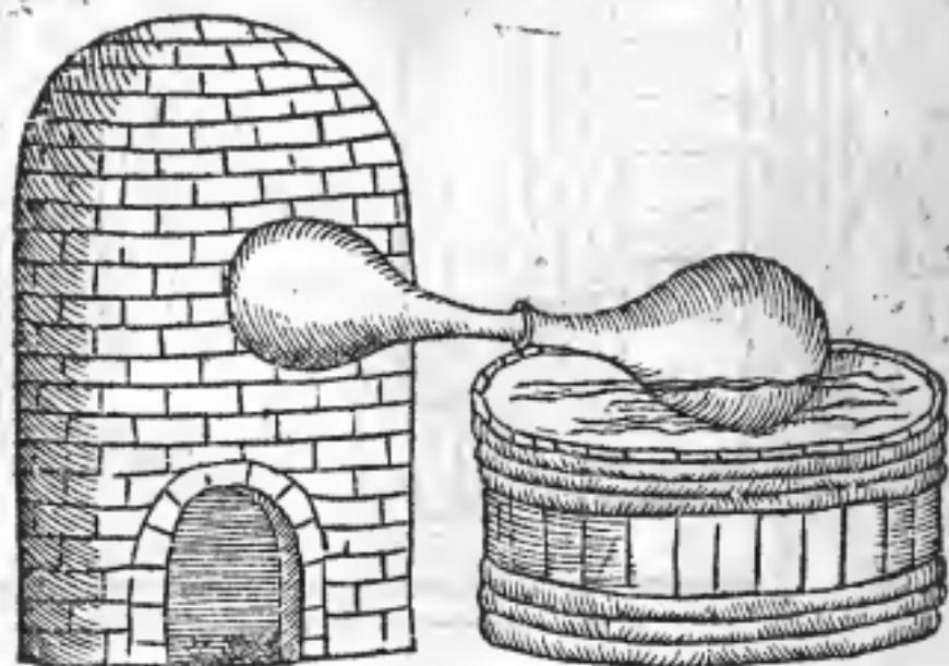
Figure d'vn fourneau & vaisseau propre à distiller l'huile de vitriol.
