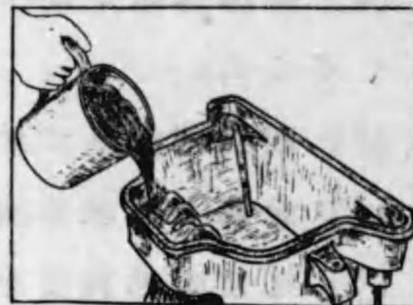
第 3.24 図 變壓器に絶縁混和物の注入
